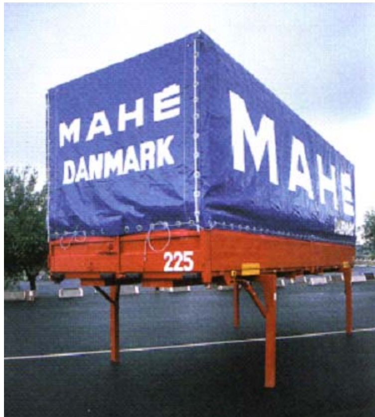
Figura 16: Cassa mobile appoggiata su gambe di sostegno
