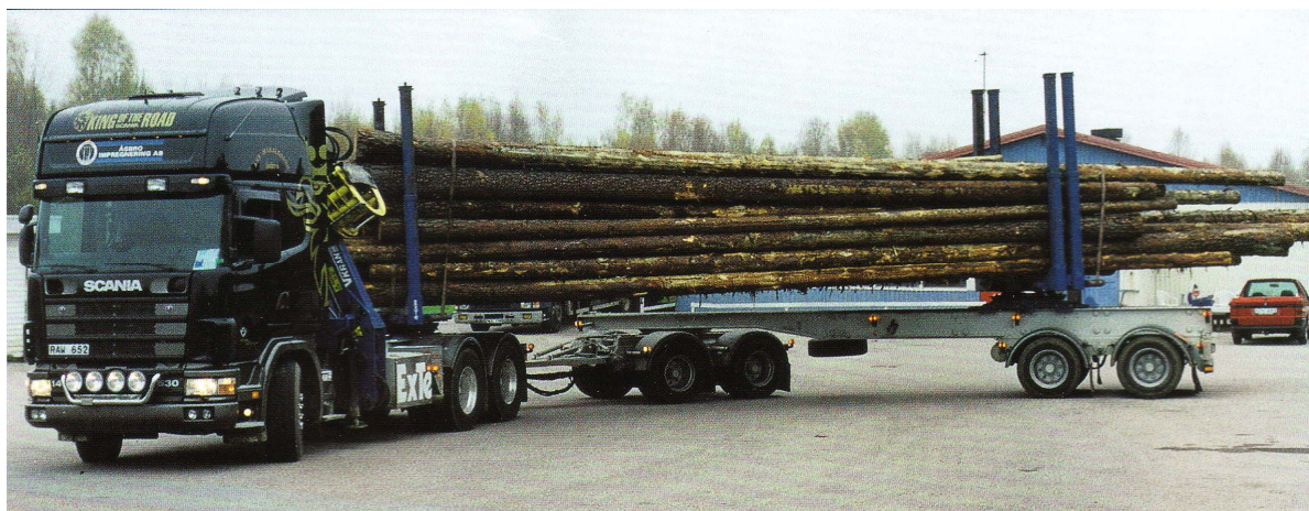
Figura 82: Trasporto di alberi interi (veicolo ad uso speciale non conforme alla direttiva 96/53/CE)
