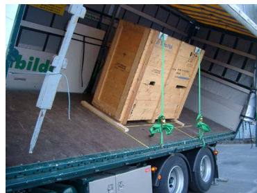
Sistemi di ancoraggio di uno scambiatore di calore sottoposti a test di resistenza all'accelerazione in avanti e di lato
